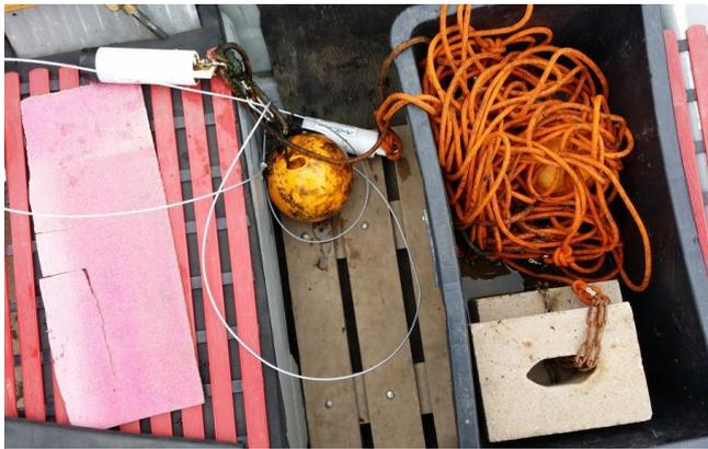
Abbildung 1: Auf dem Boot eingeholte Messkette mit Tauchboje und zwei Sauerstoffloggern links und Seil mit Temperaturloggern und Ankerstein rechts (Laacher See). © W. Frey, LfU Rheinland-Pfalz
